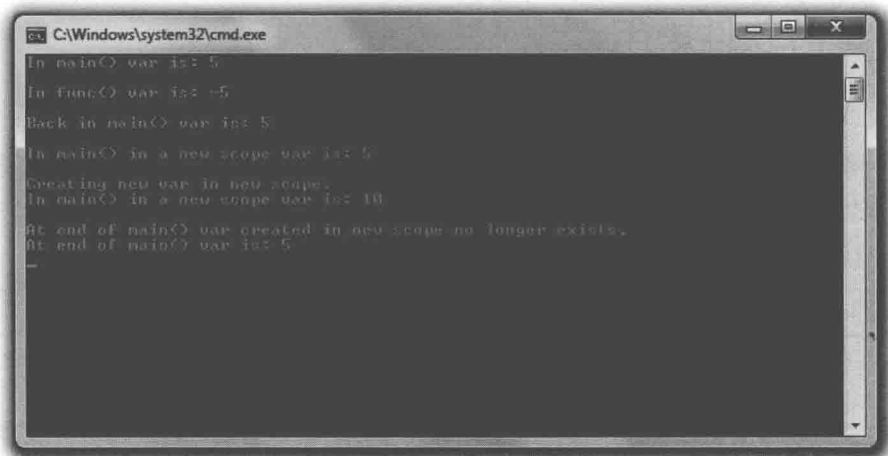
图 5.3 尽管名称相同, 但 3 个变量在其各自的作用域中都是唯一的
